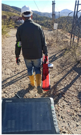
Figura N°3: Adquisición GPR Terrestre con Tablet y GPS de alta precisión
