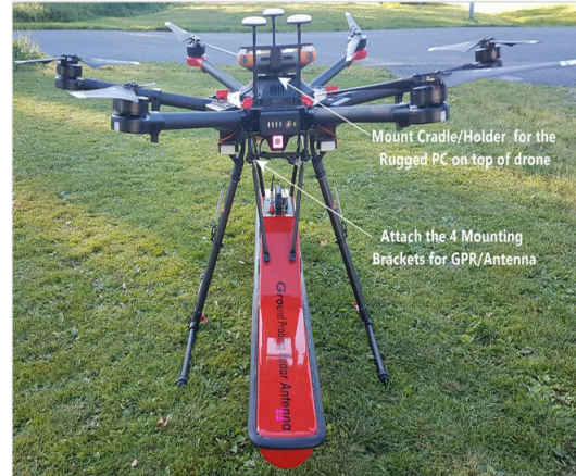
Figura N°4: Adquisición GPR integrado con Drone UAV
